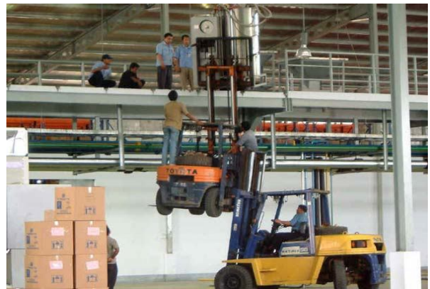
Слика 2. Пример неправилног коришћења виљушкара
