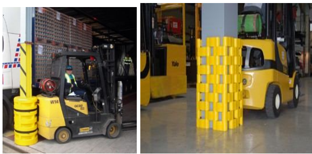
Слика 3. Заштитна опрема при раду са виљушкарком
