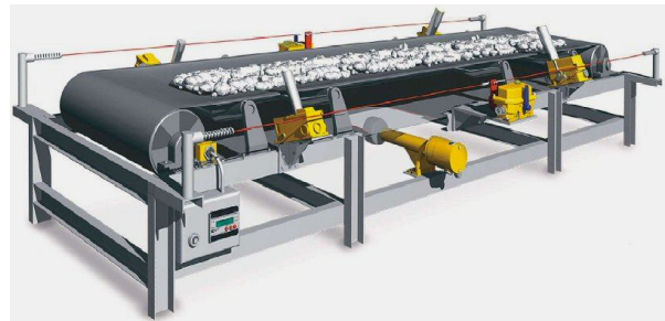
Слика 5. Сигурносни уређаји код тракастог транспортера
