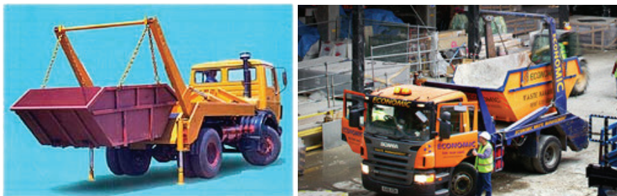
Slika 11. Vozilo za prevoženje prenosivih kontejnera
