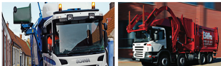
Slika 8. Vozilo sa mehanizmom za pražnjenje sa bočne ili sa prednje strane vozila
