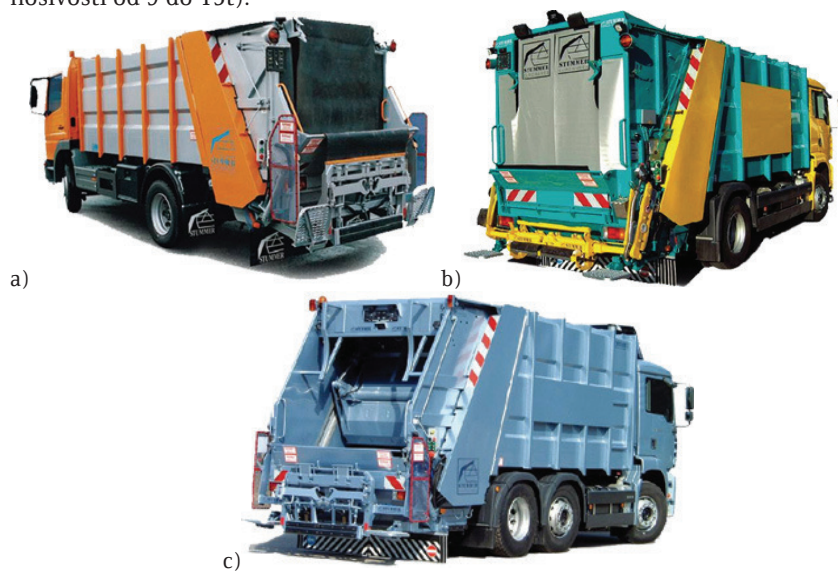
Slika 7. Vozila za sakupljanje otpada iz pokretnih kontejnera a-mini, b-medijum, c-maksi
