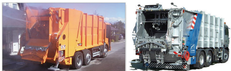
Slika 10. Vozila sa dodatnom opremom za pranje kontejnera
